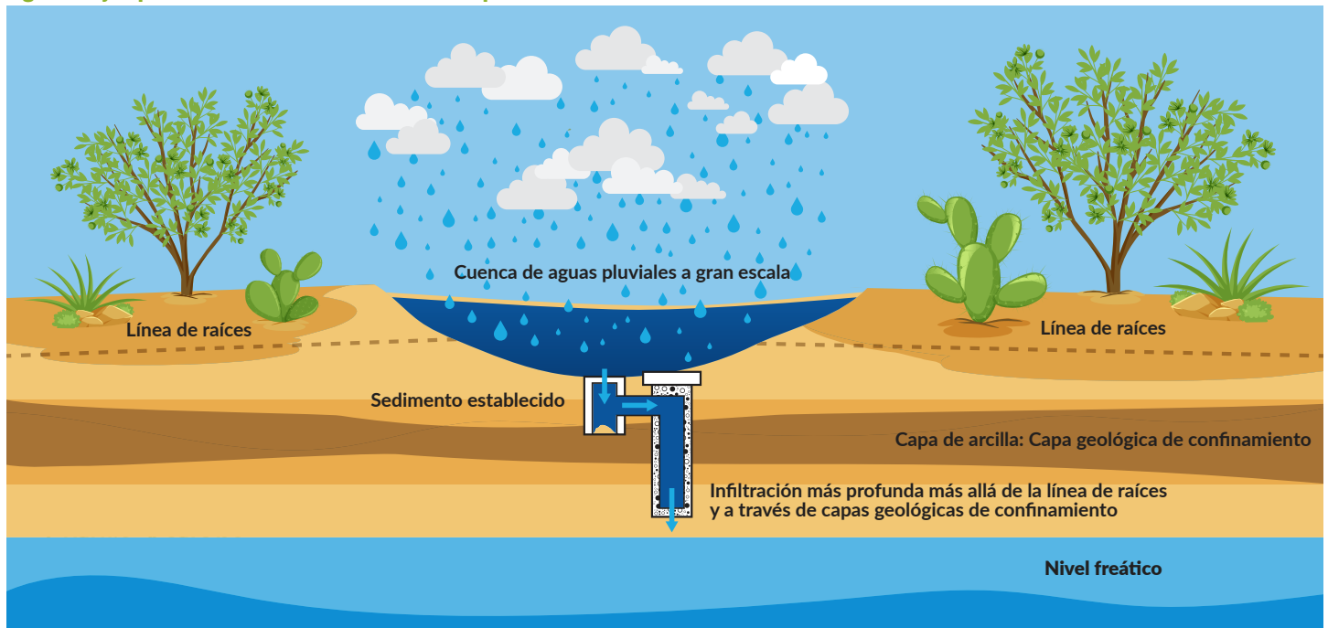
Diagrama de un método potencial para lograr la recarga de acuíferos de aguas pluviales a gran escala utilizando un pozo seco para mejorar la infiltración a través de capas geológicas confinantes y hasta un nivel freático profundo.
