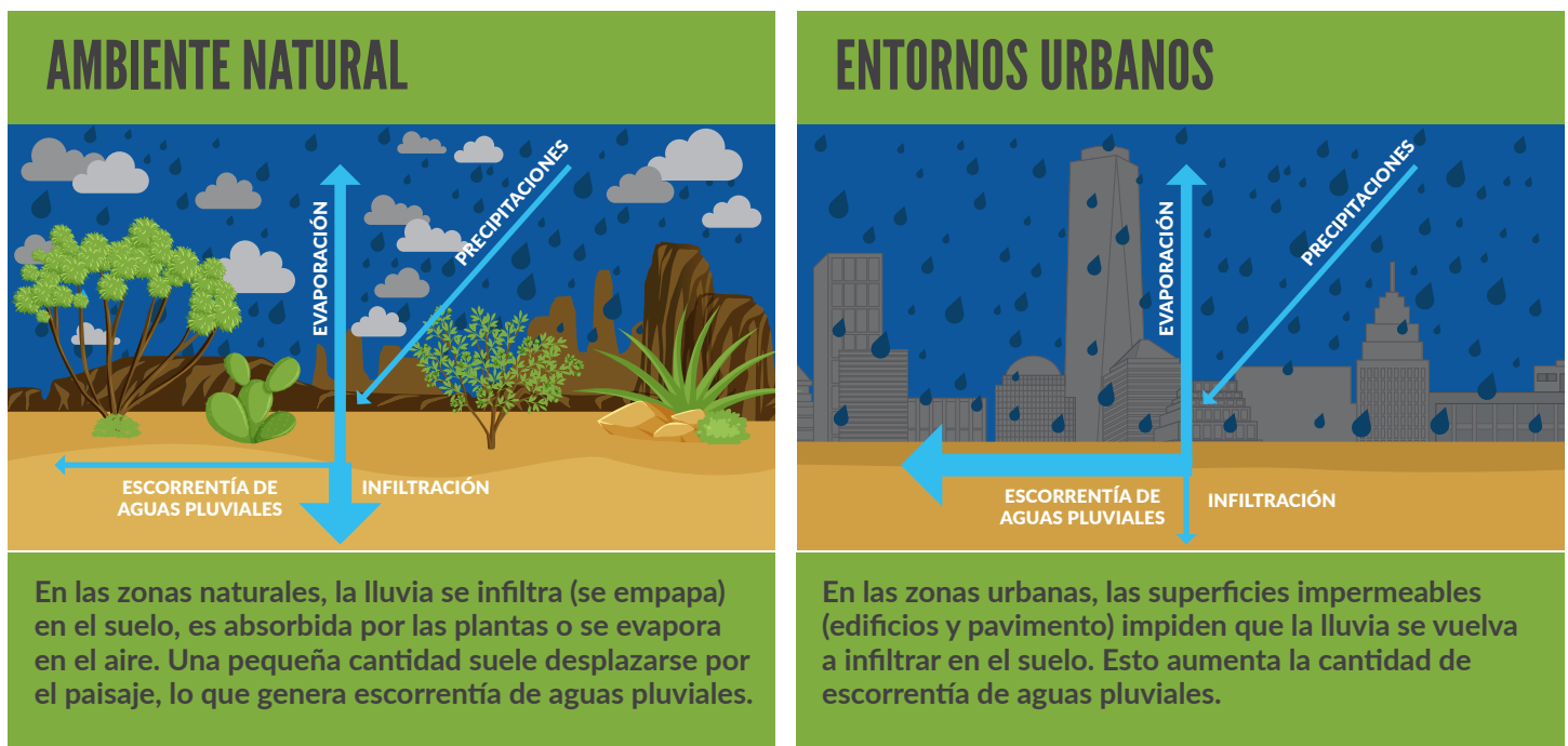
Figura 9. Compensación de la escorrentía y la infiltración de las aguas pluviales en entornos naturales y urbanos
