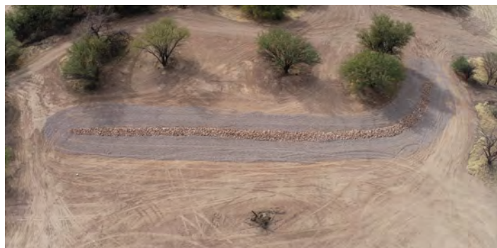
Una fotografía aérea de una zanja de infiltración instalada en diciembre de 2024 para promover la recarga del acuífero en el proyecto de la cuenca de detención de Rita Ranch.
